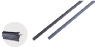
FDウッドRe:専用のコイン落下防止目地材。コインなどの小物がウッドデッキの目地部分に落下するのを防ぐ。FDクリップRe:の目地受けスリットに差し込む方式。ASA樹脂製。
