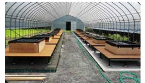
降雨などの影響で、荷重が変わらないよう温室内に試験体を設置
