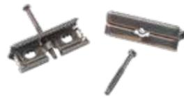
FDウッドゆらぎ専用のウッドデッキ固定部材。側面の溝を利用して固定するため、ウッドデッキ表面にビスが露出しない仕上がり。ステンレス鋼(JFE443CT)。
