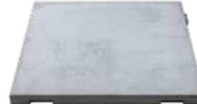
セメント、水、骨材(砂・砕石)を混ぜ合わせた二重床専用のコンクリート平板。着色には耐候性の強い無機の顔料を使用しているため一般的な経年変化以上の色褪せを防ぐ。
