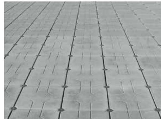
ポリスチレンフォームとモルタルを工場成型したもので、外断熱工事と歩行仕上げ工事が同時にできます。作業の簡素化、短縮化に加え、優れた断熱性能と防露効果を備えた耐久性の高い軽歩行用仕上げ材です。
