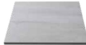
光触媒物質の酸化チタンに銀を混ぜたACTIVE SURFACES®(アクティブサーフェイス)加工が施されたイタリア製の磁器質タイル。すでに完成した磁器質タイルの上に塗布し、680度でもう一度焼き上げる。
