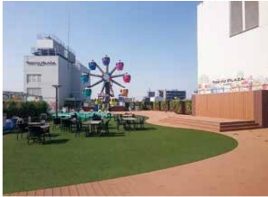
競技用のグラウンドにも使用される高品質人工芝。二種類の芝糸混織によりクッション性と耐久性を実現しました。透水性にも優れ、各種防水層の上に直接施工できるほか、「FDパネル素」の上に仕上げ材としての施工も可能です。
